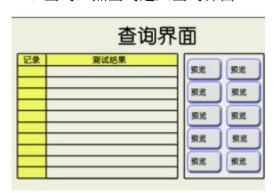
点上下页选择界面,在界面的右上角显示存储了多少条的数据。点预览进入数据查看,在界面的上端显示测试的样品、批号、时间和测试模式,可以通过上下键查询所需要的数据,点打印键进行打印,无需返回。
